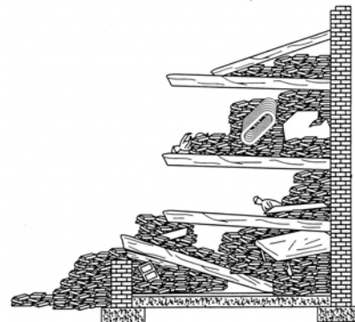
Colapso de tipo suspendido
