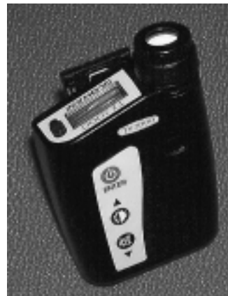
Figura 5-15: EQUIPOS DE LECTURA DIRECTA PARA GASES O VAPORES
