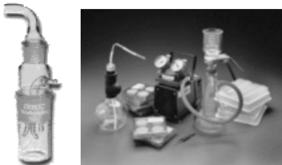
Figura 5-26: DISTINTOS MODELOS DE BORBOTEADORES Y MONTAJES
