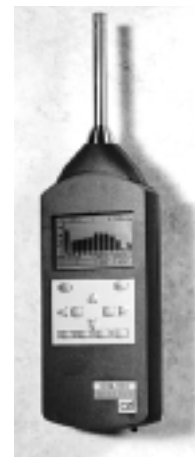
Figura 9-8: SONÓMETRO CON BANDAS DE OCTAVA
