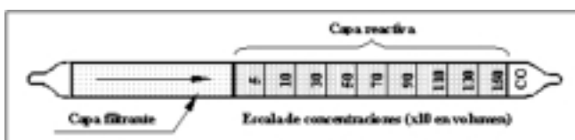
Figura 5-12: EJEMPLO DE UN TUBO COLORIMÉTRICO
