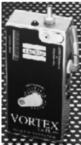
Figura 5-31: BOMBA DE ASPIRACIÓN DE BAJO CAUDAL
