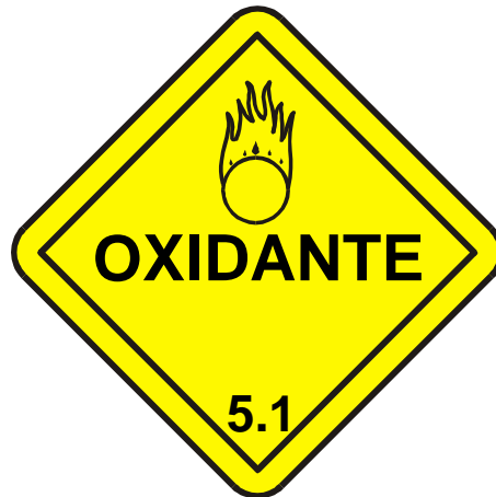
Figura 4.10 Rombo para Oxidantes
